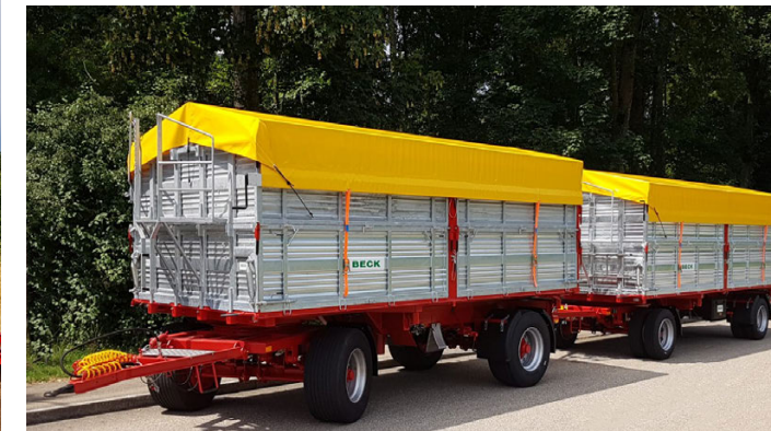
ZN 180/181 - 18 To. - 520/560 x 245 cm - 17.0/18.1 m 3 Bsp. Sonderkonstruktion mit Zwillingsreifen / Ladehöhe: 105 cm
