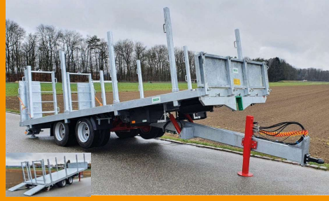
TA-S 160 / 190 / 210 - 16 / 19 / 21 To. 650 / 700 / 750 / 820 x 250 / 255 cm hydr. Heckabsenkung / basculante
