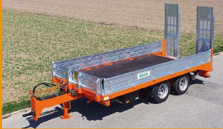
EA-S 80 / 100 / 120 - 8 / 10 / 12 To. 500 / 550 / 600 x 250 / 255 cm hydr. Heckabsenkung / basculante
