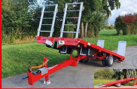
EA-S 80 / 100 / 120 - 8 / 10 / 12 To. 500 / 550 / 600 x 250 / 255 cm hydr. Heckabsenkung / basculante
