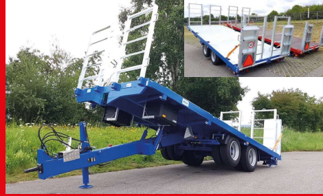
TA-S 160 / 190 / 210 - 16 / 19 / 21 To. 650 / 700 / 750 / 820 x 250 / 255 cm hydr. Heckabsenkung / basculante
