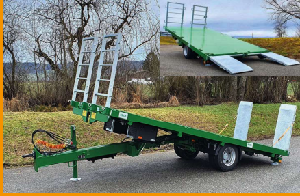
EA-S 80 / 100 / 120 - 8 / 10 / 12 To. 500 / 550 / 600 x 250 / 255 cm hydr. Heckabsenkung / basculante
