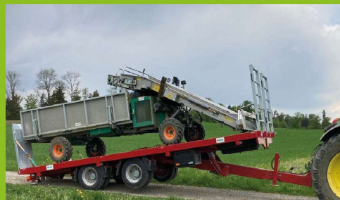
TA-S 160 / 190 / 210 - 16 / 19 / 21 To. 650 / 700 / 750 / 820 x 250 / 255 cm hydr. Heckabsenkung / basculante
