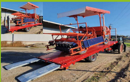
EA-S 80 / 100 / 120 - 8 / 10 / 12 To. 500 / 550 / 600 x 250 / 255 cm hydr. Heckabsenkung / basculante
