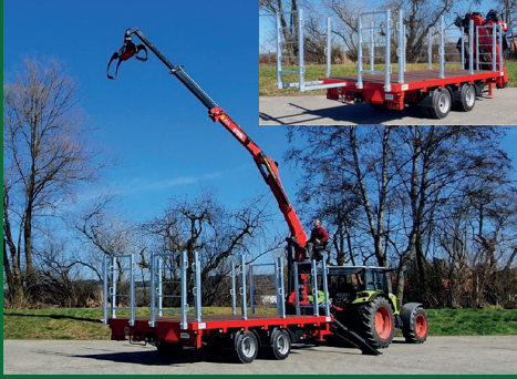
TF-K 140 / 160 / 190 / 210 - 14 / 16 / 19 / 21 To. 500 / 550 / 600 x 250 / 255 cm mit diversen Z-Kranen (mit oder ohne hydr. Schwenkdeichsel)
