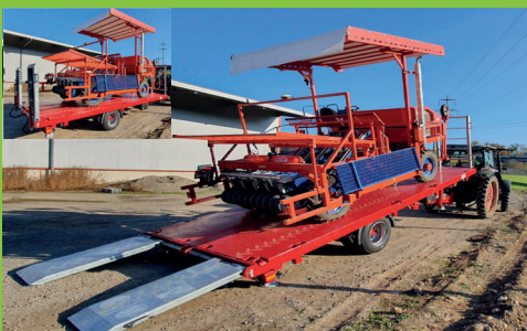
EA-S 80 / 100 / 120 - 8 / 10 / 12 To. 500 / 550 / 600 x 250 / 255 cm hydr. Heckabsenkung / basculante
