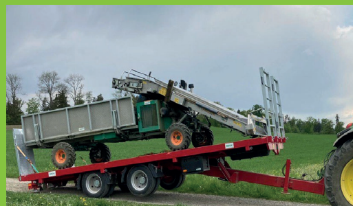
TA-S 160 / 190 / 210 - 16 / 19 / 21 To. 650 / 700 / 750 / 820 x 250 / 255 cm hydr. Heckabsenkung / basculante
