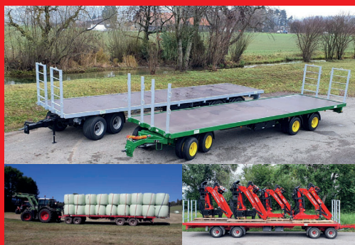
VT 320 - 32 To. - 1010 x 250 / 255 cm mit Zwillings- oder Super-Single Bereifung avec pneus jumelés ou Super-Single
